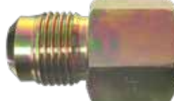
U3-8D-S (steel) 1/2" OD FLARE X 1/2" FIP
